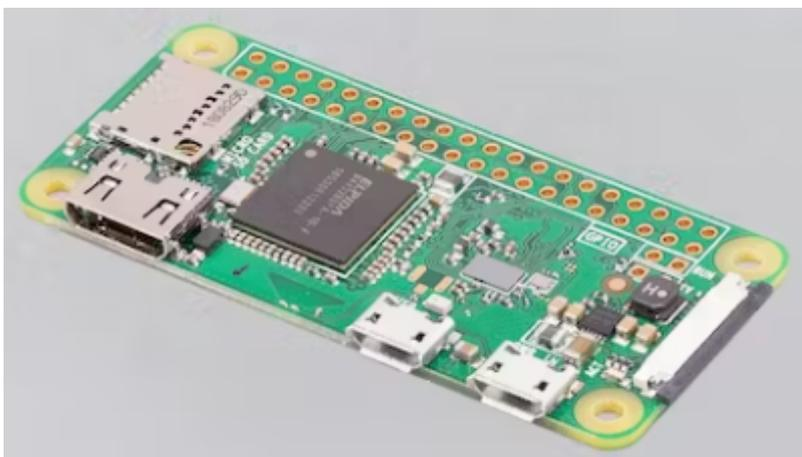
Es gibt inzwischen sehr zahlreiche Modellvarianten dieses Computers. Wir haben uns in diesem Projekt aufgrund der Baugröße und des Stromverbrauchs für einen [Raspberry Pi Zero W \(Version 2.0\)](#) entschieden - auch wenn dieser kein Onboard-Sound bietet. Für die [Variante 5](#) kommt im Projekt übrigens ein Raspberry Pi Zero WH zum Einsatz. Bei diesem ist die 40polige-GPIO-Headerleiste bereits ab Werk bestückt und man erspart sich eine ganze Menge Löterei.
