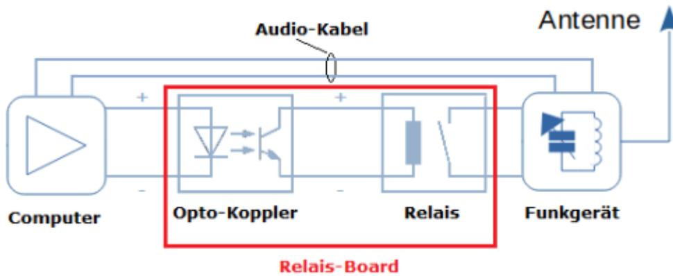
Das Relais-Board wird vom Computer aus angesteuert und simuliert somit zuverlässig und unabhängig vom Rest des Systems die Sprechtaete des Funkgerätes.
